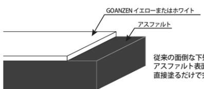
従来の面倒な下処理は不要です。アスファルト表面を掃除して直接塗るだけで完了します。
